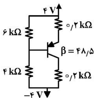
۱۰۹- جریان بیس ترانزیستور چند میلی آمپر است؟ ( $V_{BE} = 0.7V$ )
