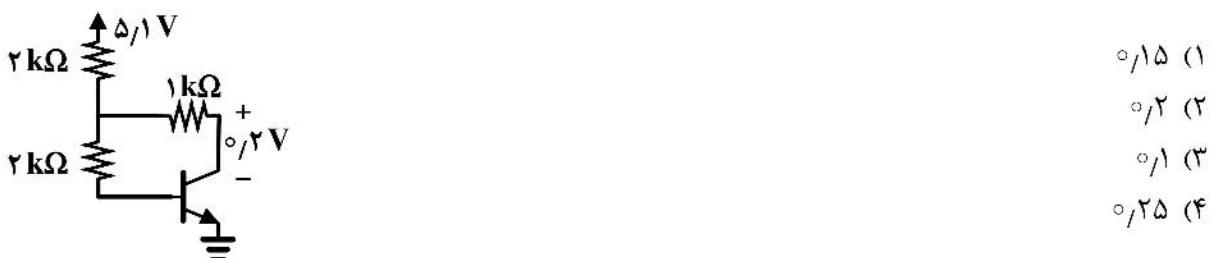
۱۰۷ - ولتاژ خروجی مدار  $V_o$  چند ولت است؟
